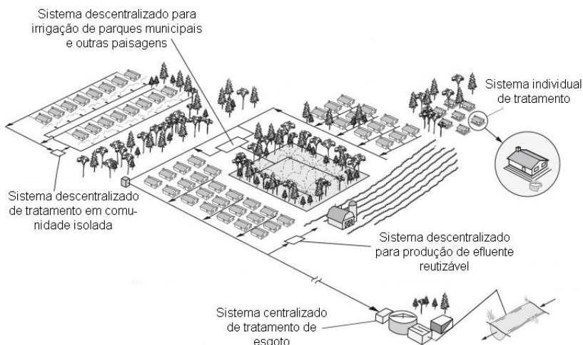
Figura 1 - Esquema ilustrativo sobre os tipos de tecnologia e seus locais possíveis de implementação.
