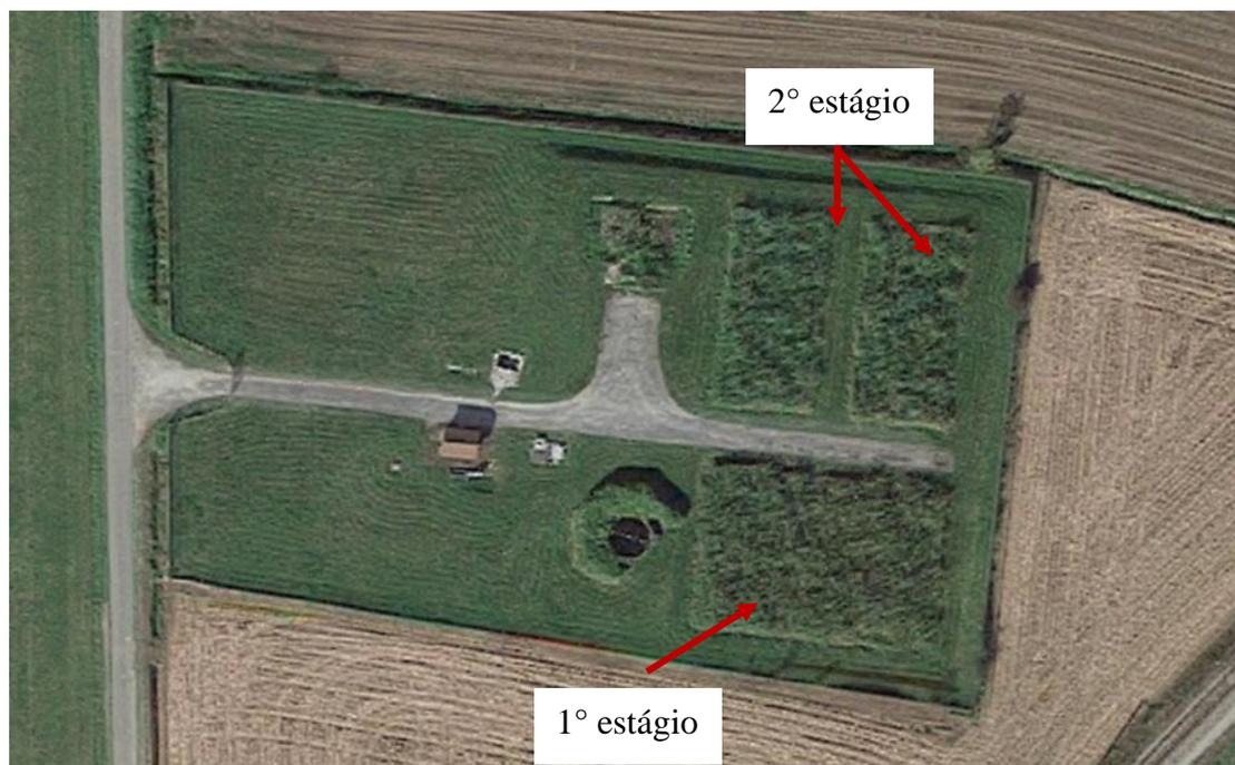
Foto 4 - Vercia e a estação de tratamento de esgoto constituída por wetland construído de fluxo vertical - sistema Francês (processo Azoé-NP®).
